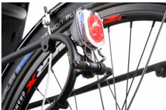
**Montage-Vorschlag bei ICE-Trikes** für die Blinkerleuchten **hinten**: Befestigung am Gepäckträger mittels mitgelieferter Winkel.
