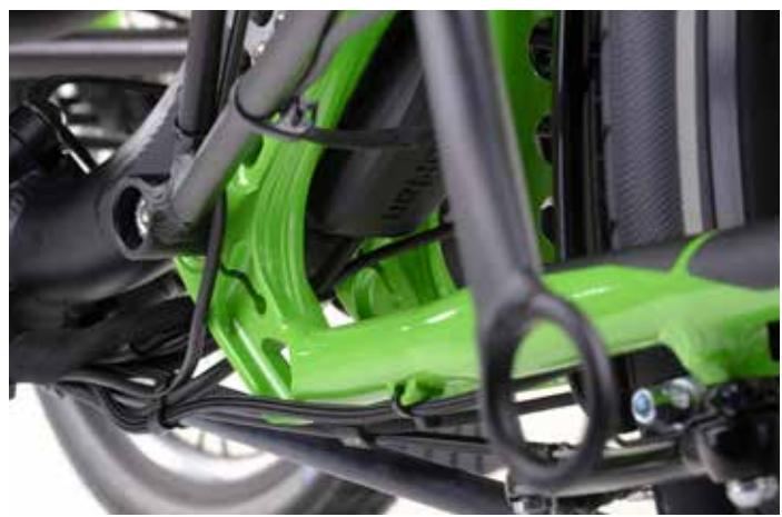
13. Verlegen Sie die Kabel entsprechend ihrer Beschriftung zu den hinteren Blinkern von der Blinkerbox abgehend nach oben und dann entlang der unteren Streben des Gepäckträgers
