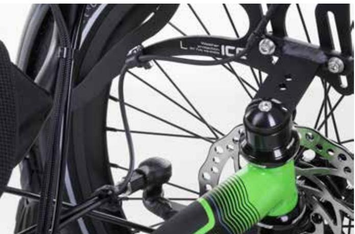
10. Verlegen Sie die Blinkerkabel wie auf der Abbildung dargestellt mit den mitgelieferten Schellen und Haltern an der Schutzblechbefestigung und mit den Jagwire-Schellen entlang der Spurstangen.
