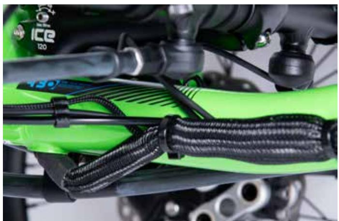
4. Verlegen Sie das Anschlusskabel für den Blinkertaster mit Hilfe der mitgelieferten Kabelclipse entlang der Zughüllen, die zum rechten Lenker gehen. Die Blinkeranschlusskabel auf Höhe des gezeigten Anlötschokels aus dem Geflechtschlauch nach oben herausführen.
