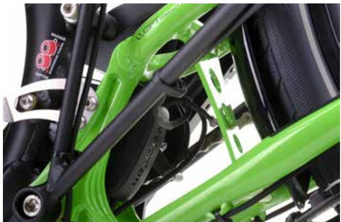
2. Montage-Vorschlag bei ICE-Trikes: Montieren Sie die Blinker-Controlbox an der Unterseite der Traverse für die Elastomerbefestigung am Hinterbau des Trikes.
