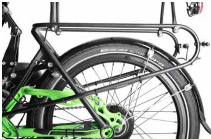
14. Befestigen Sie die Blinkerkabel an der unteren Gepäckträgerstrebe mit jeweils 5 Kabelbindern pro Seite im Abstand von 10 cm.
