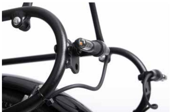
11. Schrauben Sie die Winkel mit den mitgelieferten M6x12 mm Schrauben (4 mm Inbusschlüssel und 10 mm Schraubenschlüssel) an die Bleche hinten am Gepäckträger.
