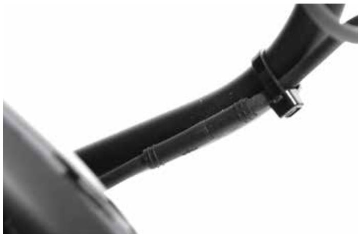
15. Verbinden Sie die Blinker mit den Blinkerkabeln der Blinkerbox. Achten Sie beim Einsticken des Steckers in die Buchse darauf, dass Buchse und Stecker fluchten und sie den Stecker bis zum Anschlag einschieben, damit die Steckverbindung korrekt montiert und abgedichtet ist.
