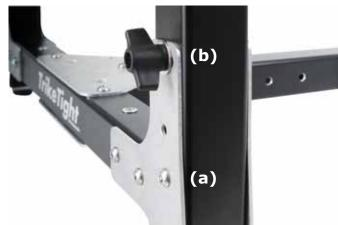
4) Zur Installation der U-förmigen Rahmenhalterungen schrauben Sie auf jede Halterung eine 3-seitige Flügelmutter und eine Unterlegscheibe. Setzen Sie das so vorbereitete Teil in das obere Gewinde des Beines ein. Die Halterungen können durch Drehen in der Höhe verstellt und mit der Flügelmutter fixiert werden.
