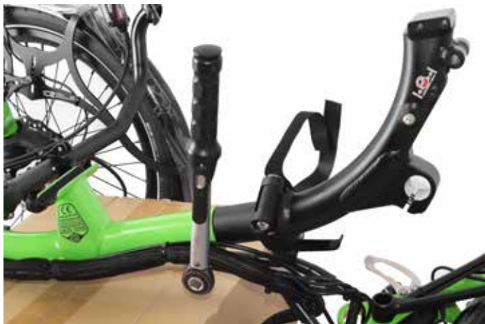
17. Nach provisorischem Ausrichten mittels Wasserwaage an der Sitzbefestigung die beiden Rahmenklemmschrauben mit neuer Schraubensicherung versehen und mit 5 mm Inbus handfest anziehen.
