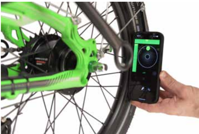
29. Durch Anlegen des Smartphones oder der Wasserwaage an der Felgenflanke überprüfen, ob der Hinterbau passend ausgerichtet ist. Ggf. durch Lösen der Rahmenklemmschrauben und Verdrehen korrigieren.
