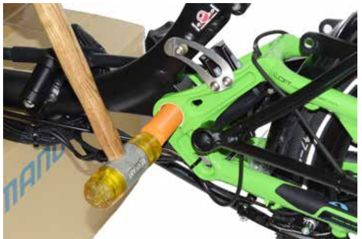
10. Den mitgelieferten Austreiber (orange) in das Schwingenlager einsetzen und mittels Gummihammer das Schwingenlager herausschlagen. Ab hier ist eine zweite Person zum Halten des Hinterbaus hilfreich.
