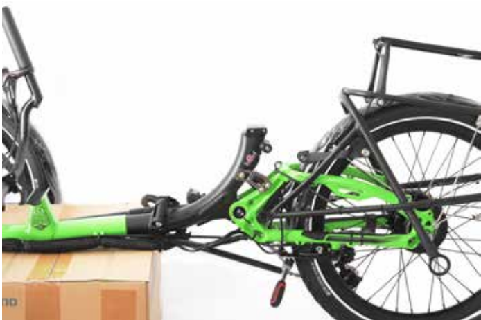
9. Beide Schrauben im Hinterbau mit 5 mm Inbus lösen.
