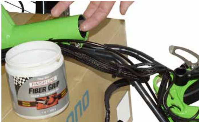
15. Das Kunststoff-Inlay vor Einsetzen des neuen Rahmenrohrs mit Faltgelenk dünn mit der mitgelieferten Carbon-Montagepaste bestreichen.
