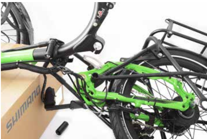
11. Den Hinterbau nach Entfernen des Schwingenlagers und des Austreibers vorsichtig beiseitelegen. Darauf achten, dass keine Kabel und Züge beschädigt oder gelängt werden!
