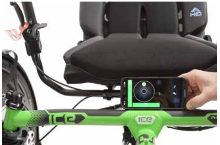
27. Ausrichten des Hinterbaus in Relation zum Hauptrahmen
