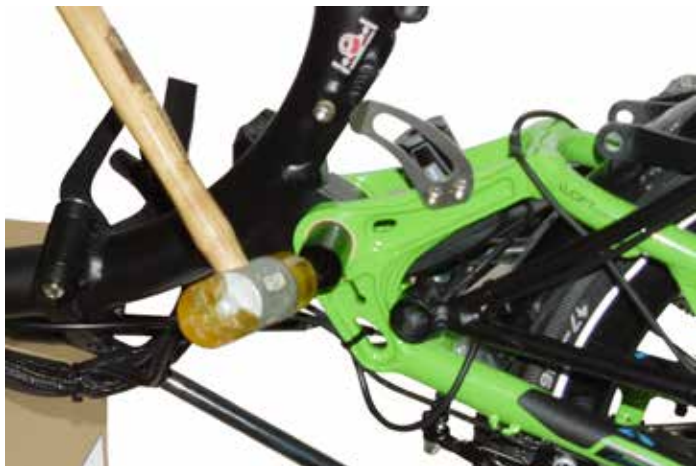
19. Die Lagerhülse mit vorsichtigen Hammerschlägen soweit einbauen, so dass sie auf beiden Seiten bündig mit den Gleitlagern sitzt.
