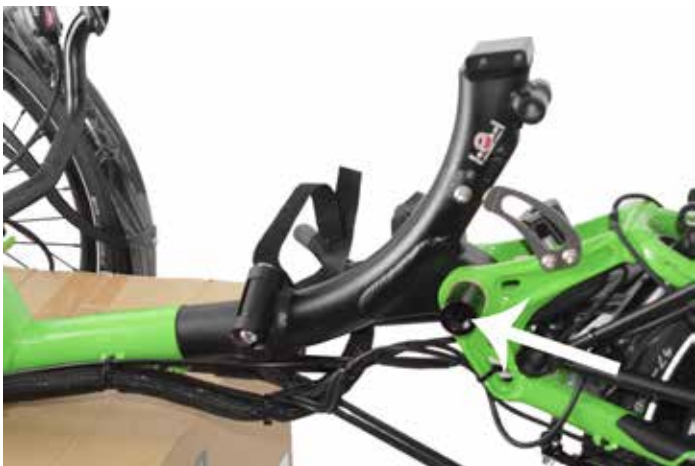
18. Den Hinterbau passend zu der Bohrung im Rahmenrohr mit Faltgelenk ausrichten und die Lagerhülse (weißer Pfeil) vorsichtig einschieben.
