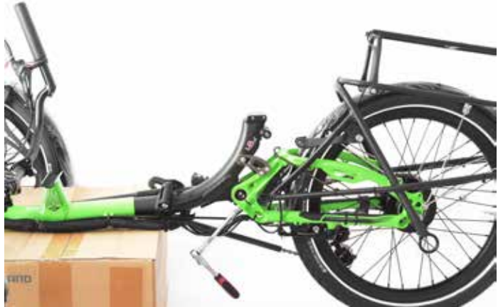
8. Beide Schrauben in Faltgelenk mit 5 mm Inbus lösen.
