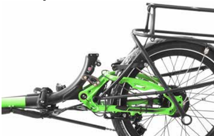
6. Untere Streben des Gepäckträgers etwas nach außen biegen und dann Gepäckträger nach hinten schieben.
