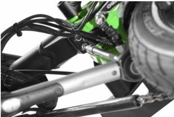
26. Klemmschrauben im Rahmenrohr mit Drehmomentschlüssel (5 mm Inbus) mit 10 Nm anziehen.
