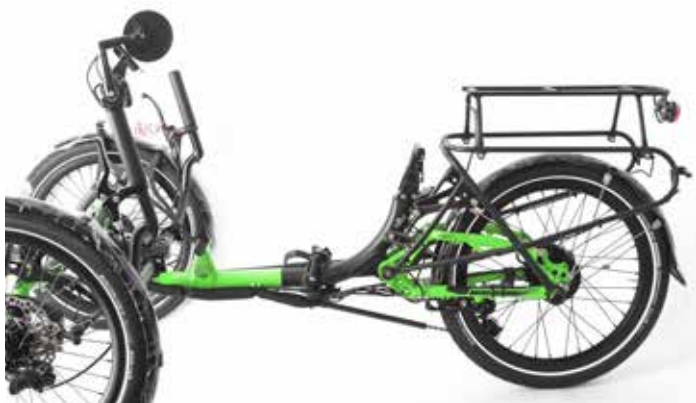
2. Sitz demontieren: Schnellspanner oben öffnen, dann beide Schnellspannschellen unten öffnen und den Sitz abnehmen.
