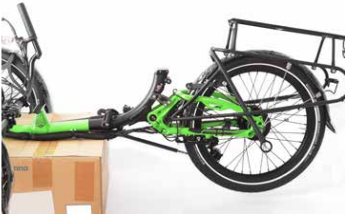
7. Den Hauptrahmen unterbauen oder das Trike auf einen Montageständer setzen, so dass das Hinterrad leicht in der Luft schwebt.
