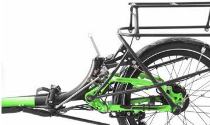
4. Nur Räder mit Gepäckträger (Schritte 4-6): Obere Schraube des Gepäckträgers mit 6 mm Inbus und 13 mm Ringschlüssel lösen.
