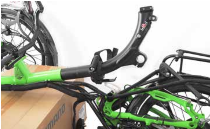
13. Kettenschutzrohr und ggf. den Kabelsatz aus der Klettschlaufe am Faltgelenk lösen.
