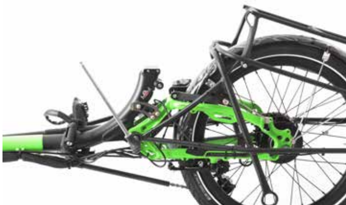
5. Untere Schraube des Gepäckträgers mit 8 mm Inbus lösen und Gepäckträger vorsichtig nach hinten kippen.
