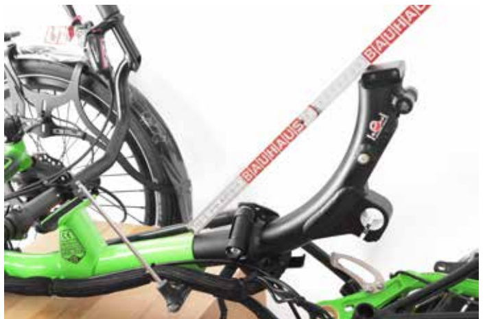
12. Vor dem Lösen der Rahmenklemmschrauben den Abstand zwischen Hauptrahmen und Sitzbefestigung mit einem Metermaß bestimmen.
