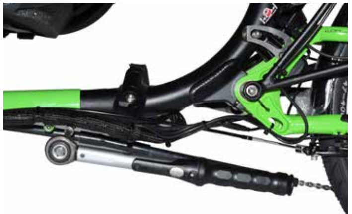
30. Die mit neuer Schraubensicherung versehenen Rahmenklemmschrauben mittels Drehmomentschlüssel mit 10 Nm festziehen.
