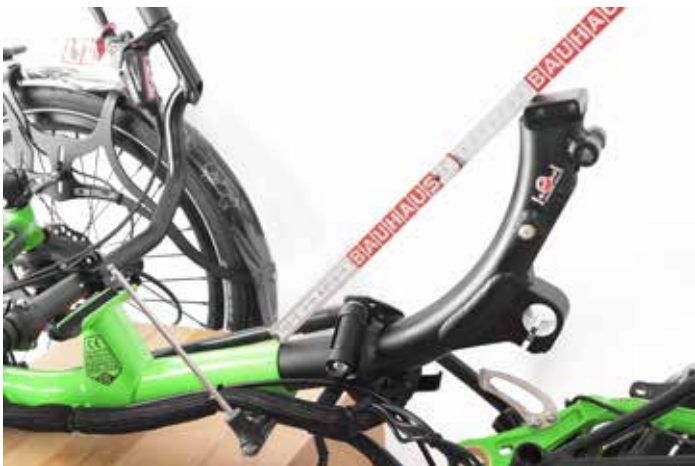
16. Das neue Rahmenrohr mit Faltgelenk in den Hauptrahmen einschieben, bis das Maß aus Schritt 12 erreicht ist.
