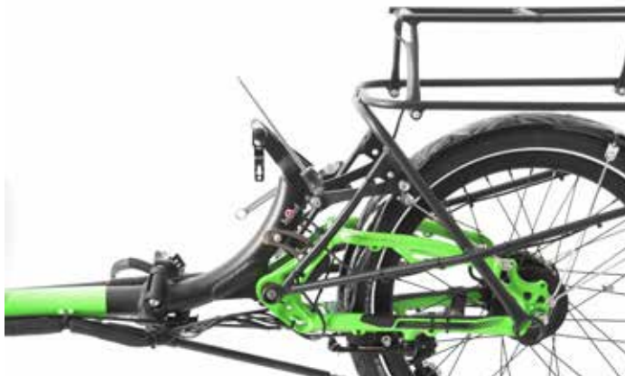
3. Nur Full Fat, Adventure und Adventure HD: Beide Schrauben am TT-Adapter mit 5 mm Inbus und 10 mm Ringschlüssel lösen und TT-Adapter beiseite legen.
